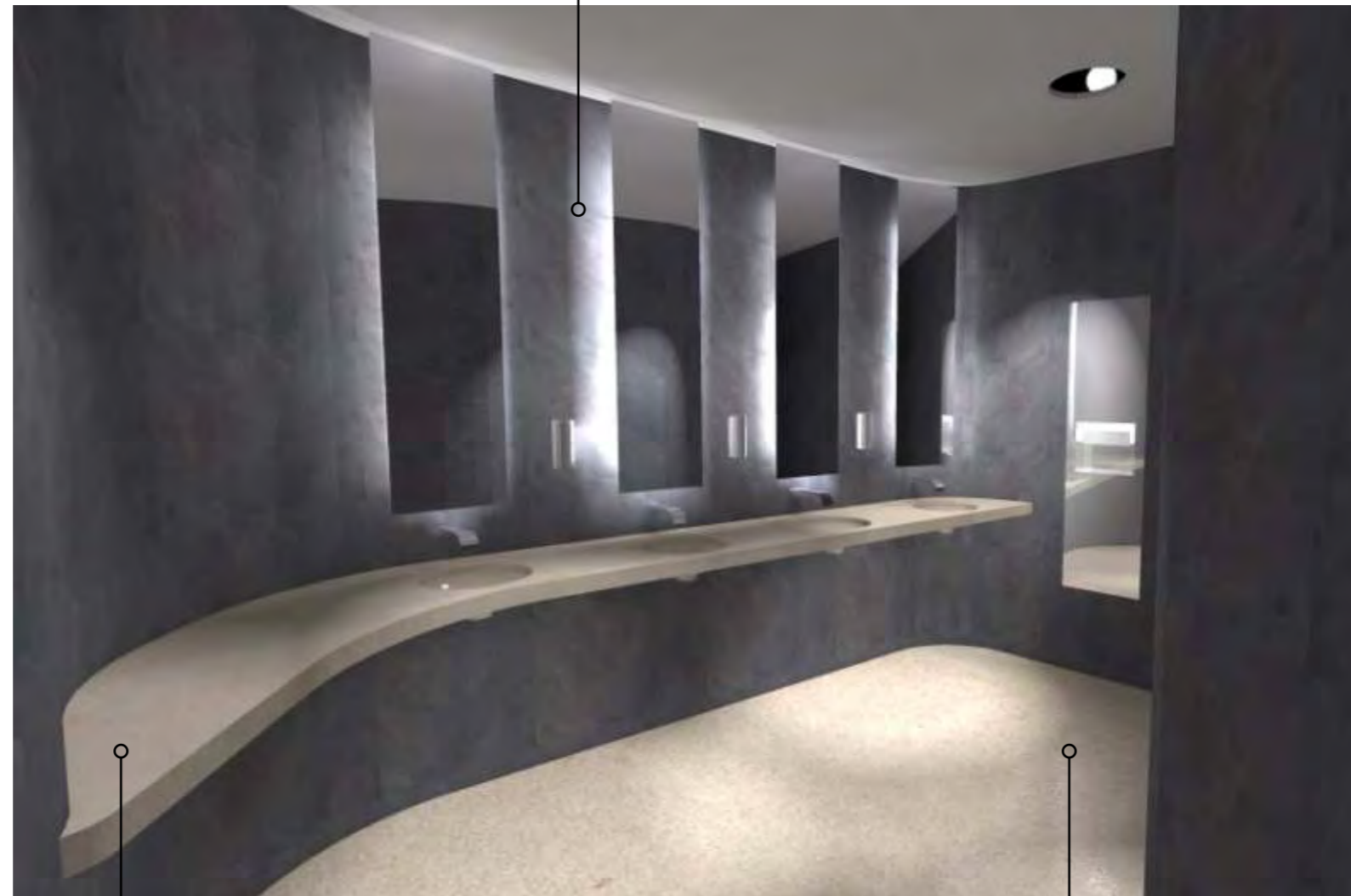
tükör világítás: - a függesztett tükör mögé rejtett fénycsöves lámpatestek
