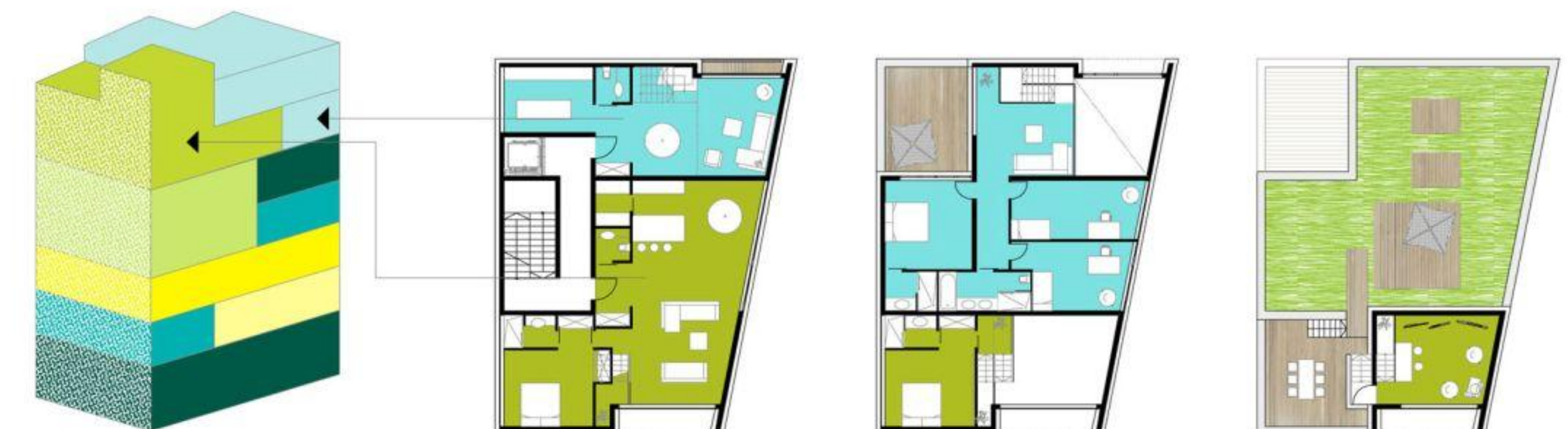
TÉRSZERVEZÉS: MEGOSZTOTT SZINTEK, DUPLA BELMAGASSAGÚ TEREK, TÉRJÁTÉK FUNKCIÓ: IRODA, MŰTEREMLAKÁS, ALKOTÓSTÚDIÓ 100-140 M 2 ALAPTERÜLET
