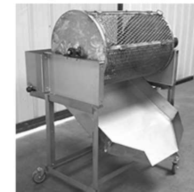
84.kép - Motoros meghajtású paprika pító hordó
