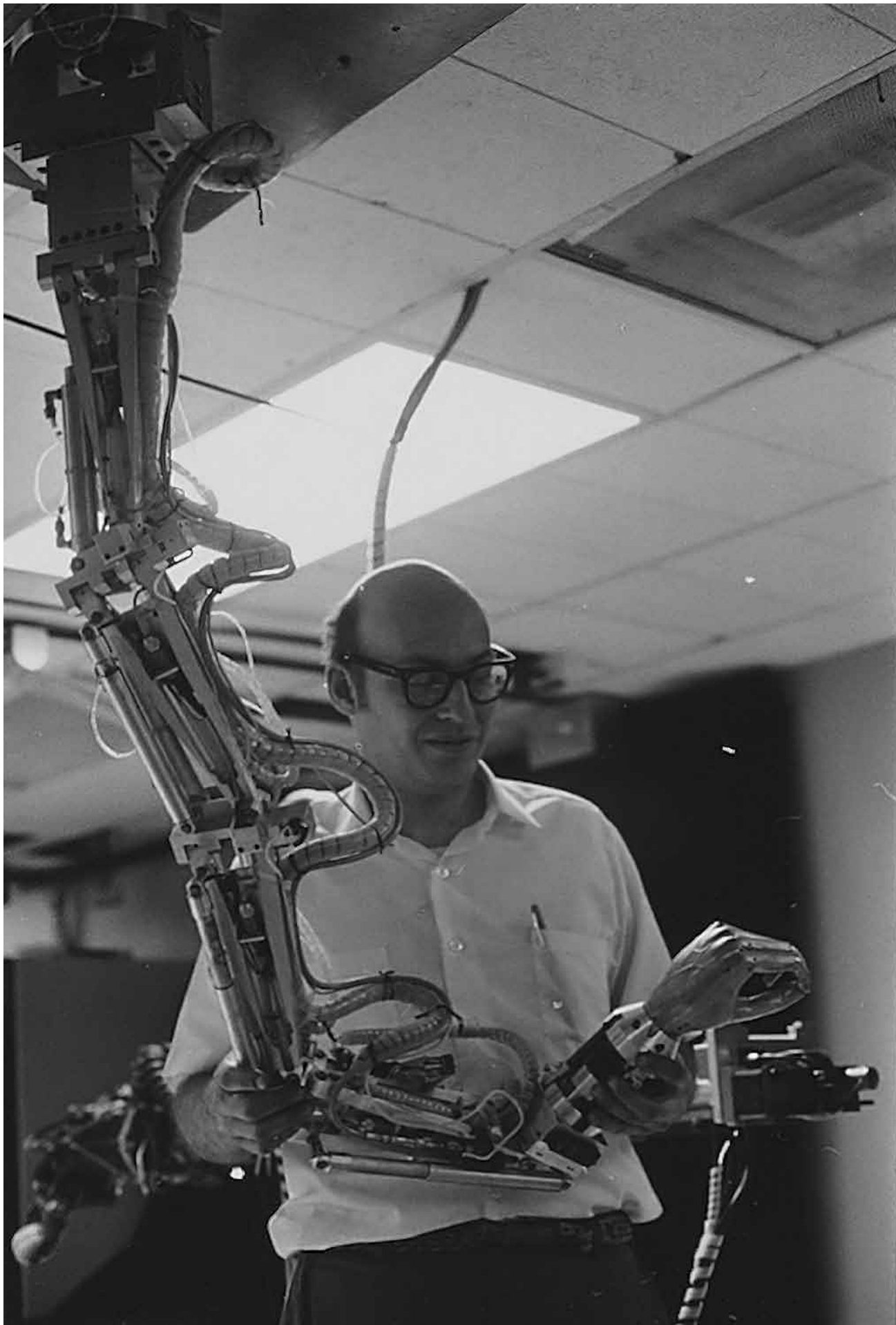
MA-3 Роботска рука са Београдском шаком, Марвин Мински држи роботску руку Фотографија са Одељења за електротехнику, из брошуре одељења, средина 1970-их, MIT Музеј, Кембриџ, Масачусетс Ајван Масар, фотограф; љубазношћу MIT Музеја
